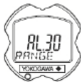
内藏指示计上自诊断故障 (变送器出错)
