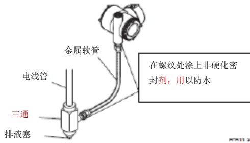
图 5.10 典型金属软管配线
